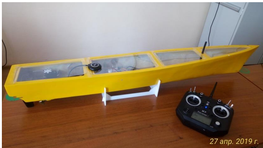
Рис.3 Окончательный вариант катера для замера глубин
