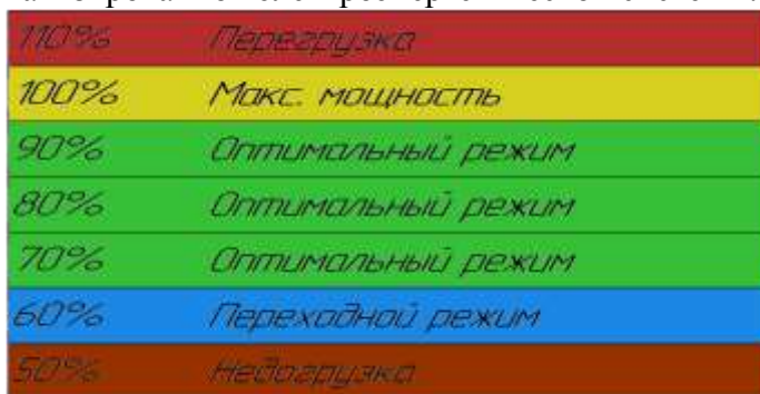
Рисунок 1 – Режимы работы дизель-генератора
