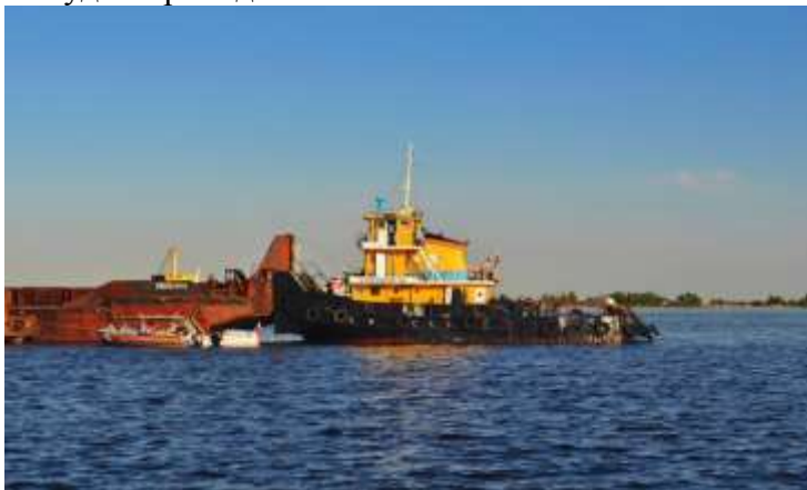
Рис. 1. Буксир - толкач проекта 887А «Шлюзовой-82»
