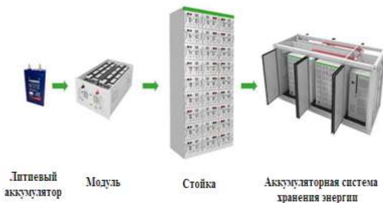
Рис. 2. Процесс формирования аккумуляторной системы хранения энергии из отдельных литиевых ячеек
